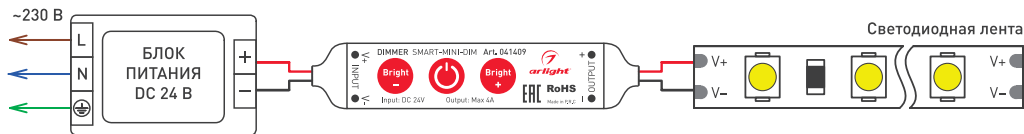
Рисунок 1. Схема подключения диммера SMART-MINI-DIM
